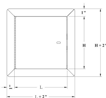
L'ouverture dans le mur = dimensions de la porte + 1/4 ou + 6mm
