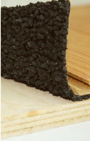
INSONOBOIS est une membrane composée de polyéthylène haute densité recouverte de petits granules de caoutchouc recyclés. INSONOBOIS a été spécialement conçu pour permettre l'insonorisation sous les revêtements de plancher stratifié synthétique (plancher flottant), lequel peut être installé directement sur la membrane. Il peut aussi être utilisé avec plusieurs autres types de revêtement de sol, tels que le bois massif ou le bois d'ingénierie multicouche.
