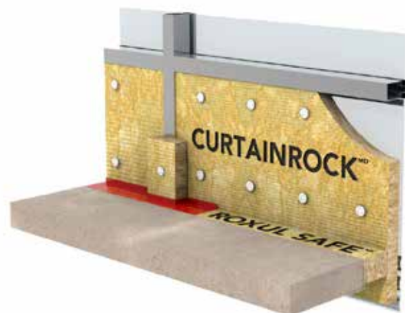
Composantes : dalle de plancher en béton, ROXUL SAFE MC , mastic d'étanchéité résistant au feu, couvre-meneau - CURTAINROCK MD , meneau, montants renforcés, panneau d'allège.
