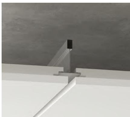
**SCD (Semi-dissimulé)** - Avec la bordure semi-dissimulée, le plafond semble flotter sous les profilés de suspension grâce à la bordure profilée et aux profilés de suspension profondément encastrés. La bordure SCD donne au plafond un aspect d'ombre élégant et caractéristique avec une ombre de 1/4". Les panneaux à bordure SCD sont démontables.
