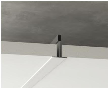
**SQ (suspensions en T)** - Les panneaux SQ sont une solution économique qui permet d'accéder facilement aux installations dissimulées derrière le plafond. Elles sont habituellement montées dans des systèmes de suspension avec des profilés de 9/16" ou 15/16". Le profilé plus étroit de 9/16" est moins apparent. Les panneaux de bordure SQ sont démontables.
