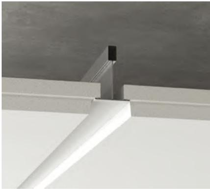
**SL, SLT et SLN (Tégulaires)** - Les panneaux à bordures tégulaires sont suspendus à un système de suspension visible et encastrée, qui crée une ombre entre les panneaux. Les panneaux tégulaires sont carrés (SL, SLN) ou à angle (SLT) et peuvent être montés dans un système de suspension avec des profilés de 9/16" (SLN) ou 15/16" (SL, SLT). Le profilé plus étroit de 9/16" est moins apparent. Les panneaux de plafonds à bordure tégulaire sont démontables.
